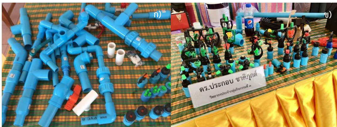
ภาพที่ 4.8 ชุดอุปกรณ์สำหรับการฝึกทักษะ ก) ท่อทาง และ ข) หัวสปริงเกอร์หรือหัวพ่นน้ำแบบต่างๆ
