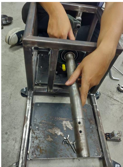
รูปที่ 3.8 ติดตั้งมอเตอร์และเพลา
