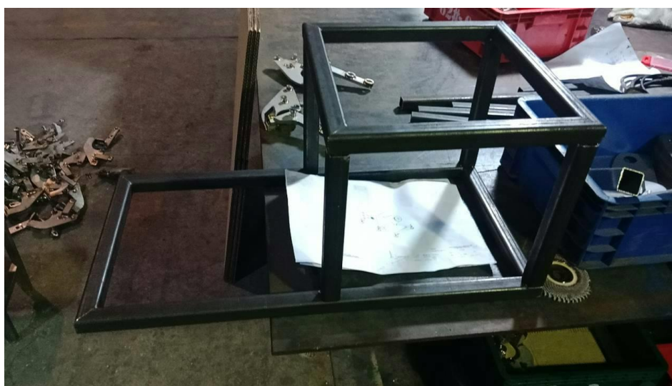
รูปที่ 3.7 เชื่อมและตรวจสอบรอยเชื่อมของโครงเครื่อง
