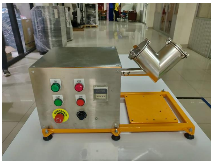
รูปที่ 3.11 ตรวจสอบเครื่องผสมผงวัสดุแบบ V-blender ที่ประกอบเสร็จแล้ว
