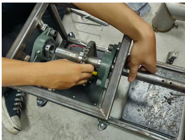
รูปที่ 3.9 ติดตั้งชุดส่งกำลังด้วยโซ่
