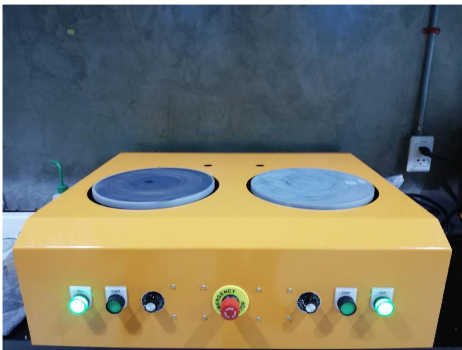
รูปที่ 4.8 เครื่องขัดชิ้นงานทดสอบที่ออกแบบสร้าง
