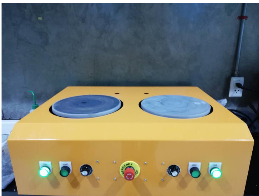
รูปที่ 4.7 เครื่องขัดชิ้นงานทดสอบที่ออกแบบสร้าง
