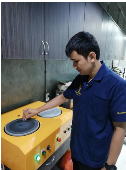
รูปที่ 4.14 ขีดชิ้นงานกับเครื่องขีดชิ้นงานทดสอบที่ออกแบบสร้าง
