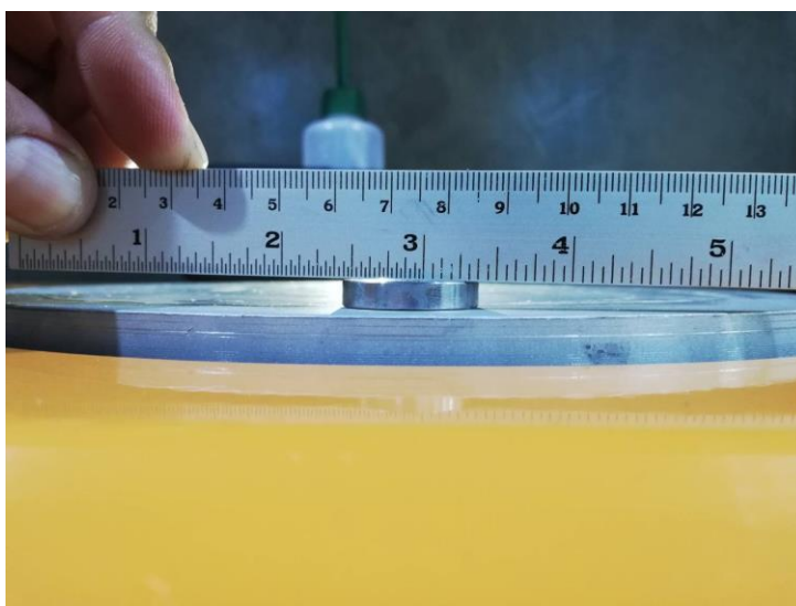
รูปที่ 4.17 ความเรียบผิวชิ้นงานหลังการขัดด้วยเครื่องขัดชิ้นงานทดสอบที่ออกแบบสร้าง
