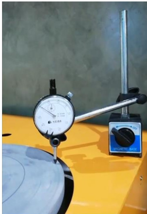
รูปที่ 4.10 ติดตั้งไดอัลเกจที่หน้างานขัดเครื่องขัดชิ้นงานทดสอบที่ออกแบบสร้าง
