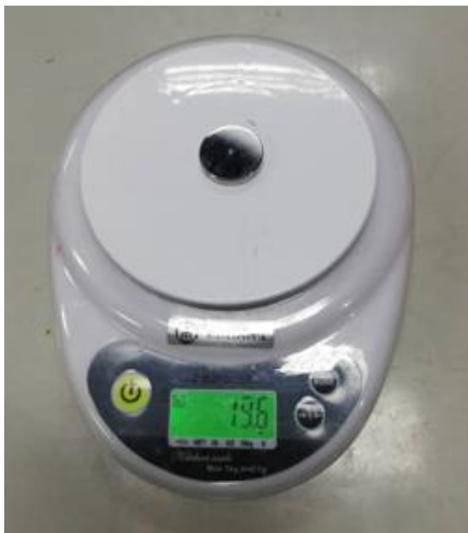
รูปที่ 4.4 เครื่องชั่งน้ำหนักแบบโพลดเซลล์
