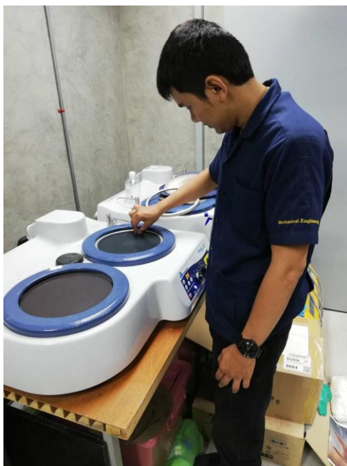
รูปที่ 4.15 ชัดขึ้นกับเครื่องชัดขึ้นงานทดสอบที่มีจำหน่ายทั่วไป
