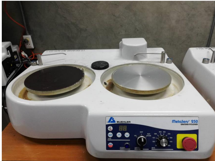
รูปที่ 4.9 เครื่องขัดชิ้นงานทดสอบแบบที่มีจำหน่ายทั่วไป
