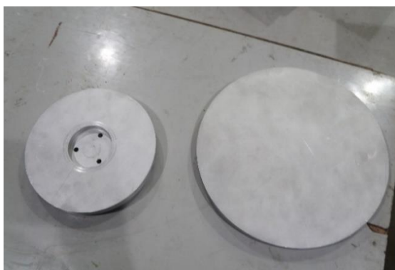
รูปที่ 3.7 ฐานจานขัดและจานขัดชิ้นงานทำจากอลูมิเนียม
