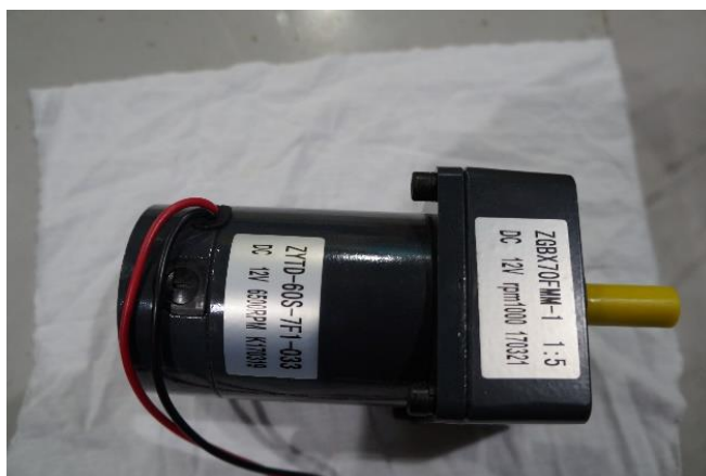
รูปที่ 3.8 มอเตอร์ไฟฟ้ากระแสตรง ขนาด 12VDC 35W
