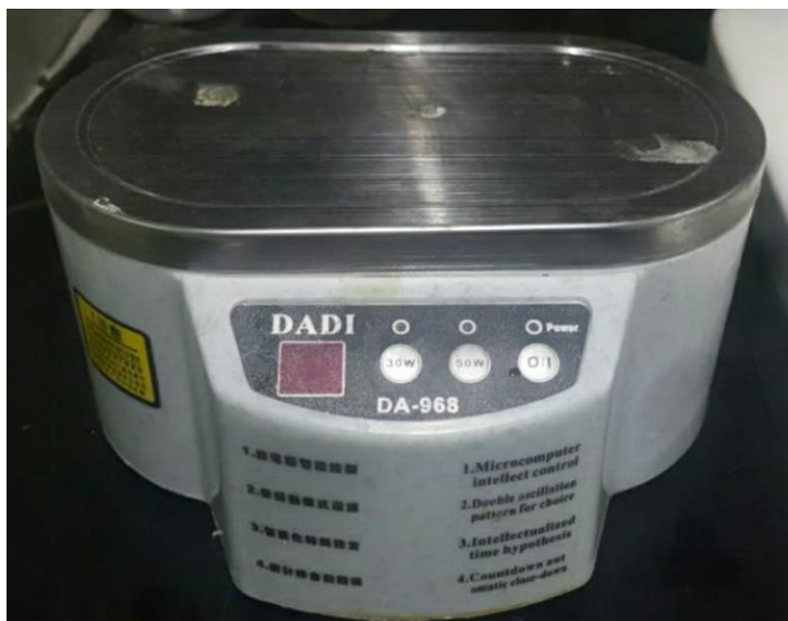
รูปที่ 4.5 เครื่องทำล้างความสะอาดชิ้นงาน
