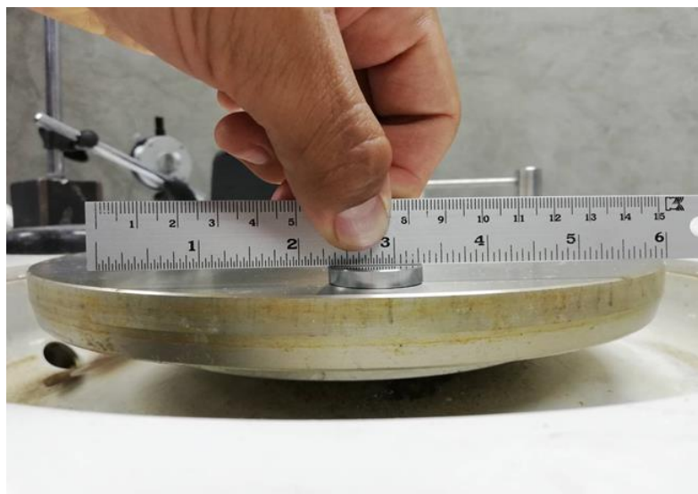
รูปที่ 4.18 ความเรียบผิวชิ้นงานหลังการขัดด้วยเครื่องขัดชิ้นงานทดสอบที่มีจำหน่ายทั่วไป
