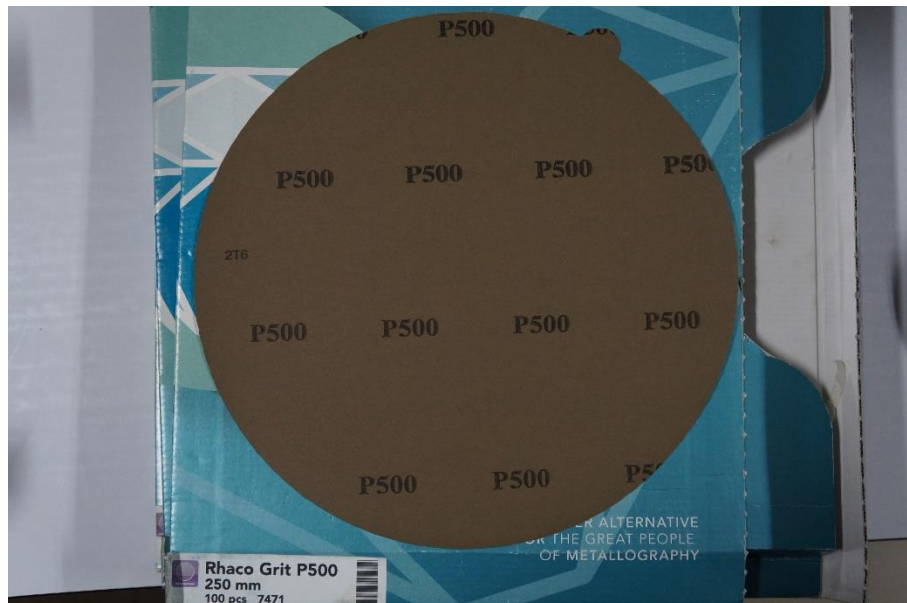
รูปที่ 4.12 ติดกระดาษทรายขัดน้ำลงบนหน้างานขัด
