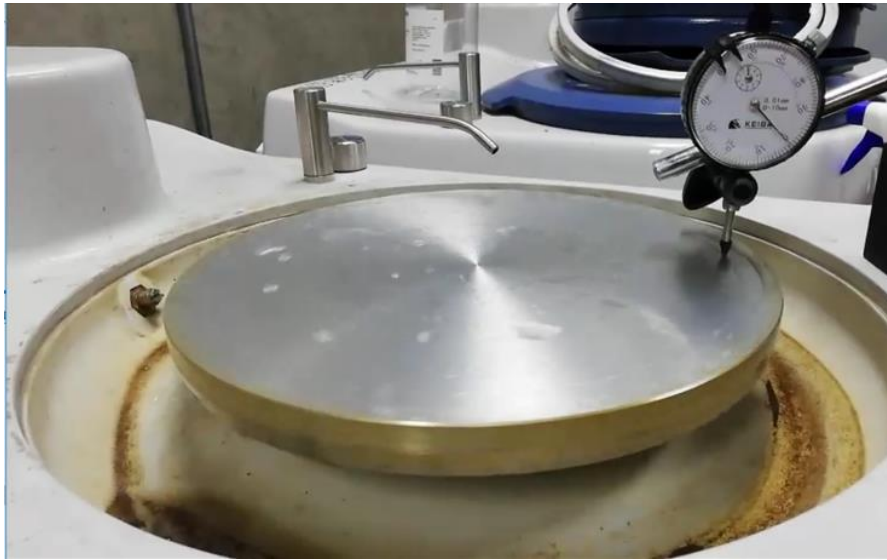
รูปที่ 4.11 ติดตั้งไดอัลเกจที่หน้างานขัดเครื่องขัดชิ้นงานที่มีจำหน่ายทั่วไป
