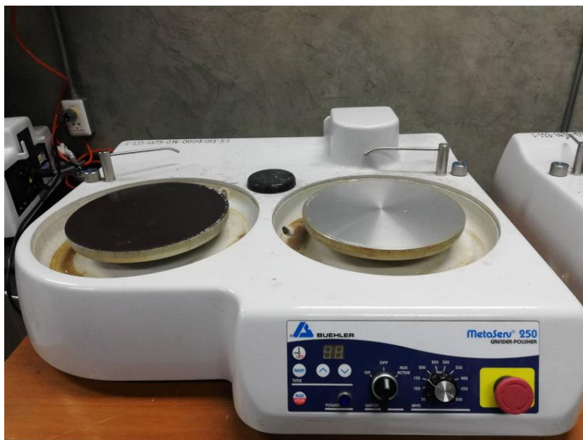
รูปที่ 4.6 เครื่องขัดชิ้นงานทดสอบแบบที่มีจำหน่ายทั่วไป
